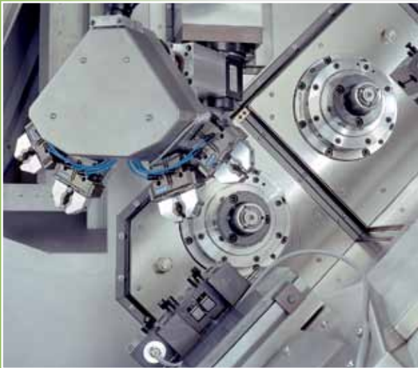
▲ Arbeitsraum mit Schwenklader muFuture B5
