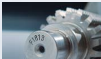
Lasertiefengravur auf Wälzfräser für Verzahnung.
