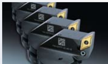
Palettierte Beladung und automatisierte Beschriftung von Werkzeugaufnahmen.
