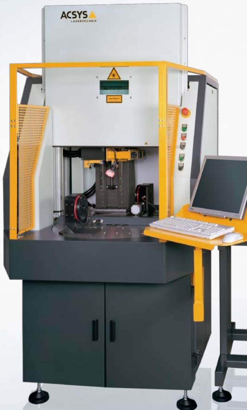
BARRACUDA mit Beladehilfe und reversierendem Rundtisch zur hauptzeitparallelen Beladung.
